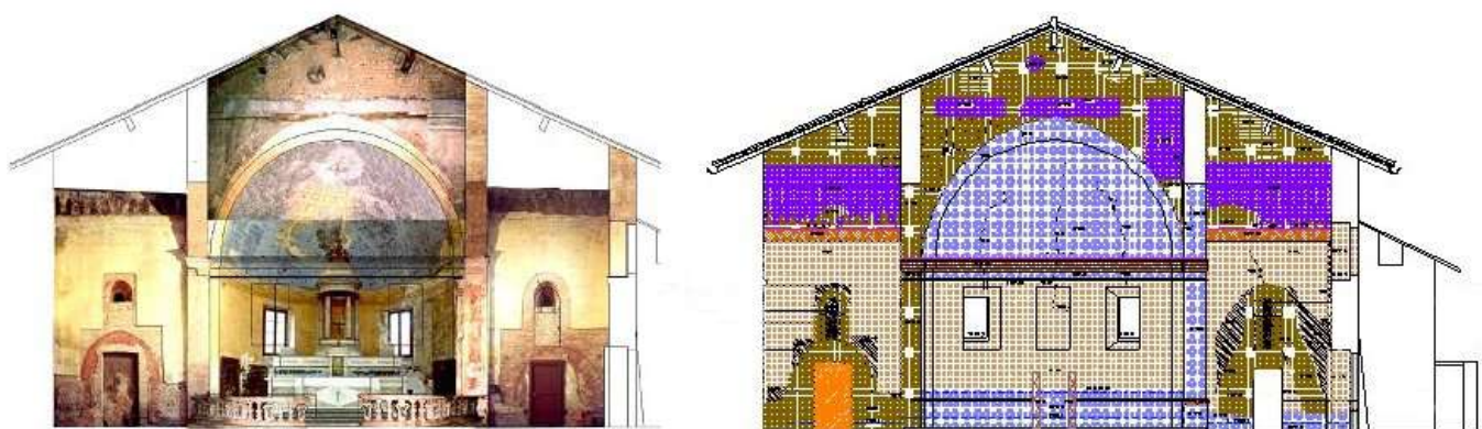
Fig. 13. A sinistra: rilievo materico (fotoraddrizzamento); a destra: rilievo del degrado e proposte d'intervento.
