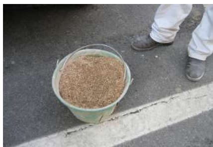
Fig. 28. Campioni di malta per l'integrazione puntuale dei giunti mancanti, utilizzando sabbie di cave locali.
