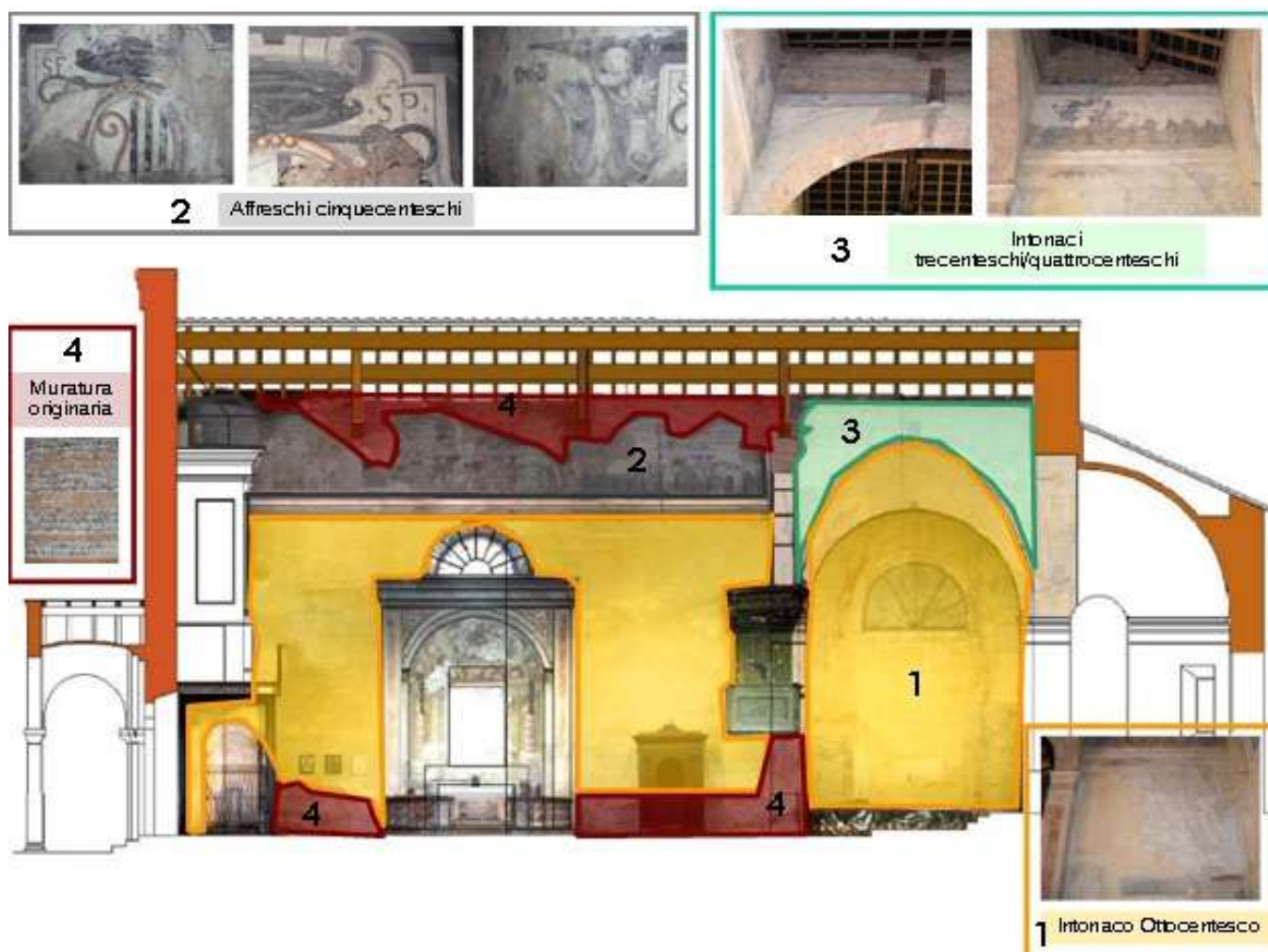
Fig. 16. Individuazione delle finiture appartenenti alle diverse fasi evolutive della chiesa.
