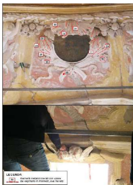
Fig. 16. Rilievi delle armature mediante pacometro.
